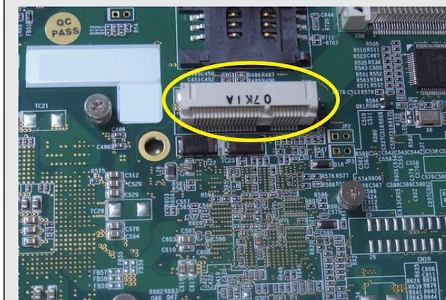
Insert VMX-200 card into mini PCIe slot
